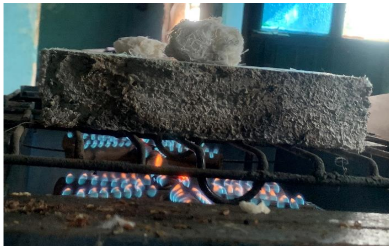
Figura 3.26 Tiempo máximo de exposición al fuego en ladrillos
