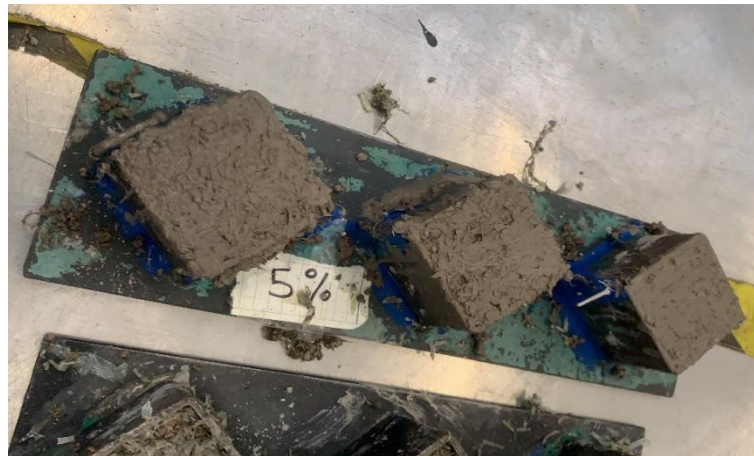
Figura 3.8 Mezcla de LDPE y concreto introducida en molde de mini bloque
