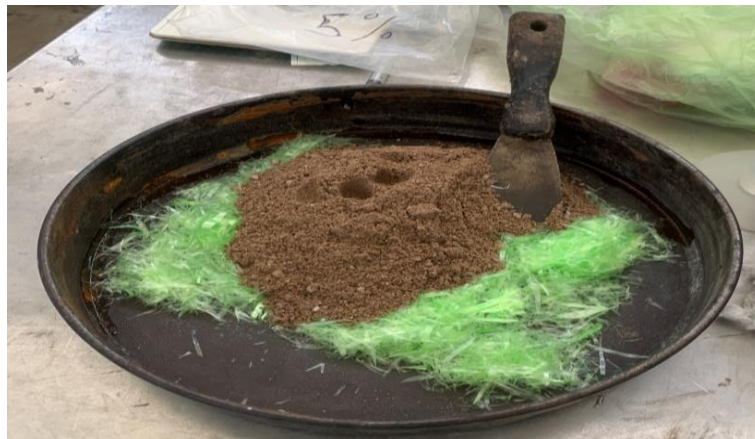
Figura 3.10 Mezcla de LDPE y arena.
