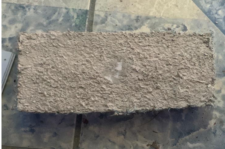
Figura 3.15 Ladrillo de concreto modificado con LDPE terminado.
