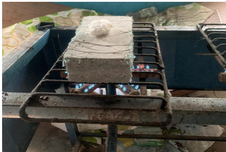
Figura 3.25 Especímen sometido a calor directo en prueba de resistencia al fuego.
