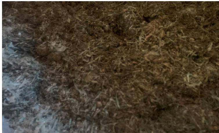
Figura 3.12 Mezcla total de materiales utilizados para la elaboración de tabiques.
