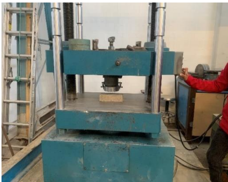
Figura 3.17a Especimen colocado sobre la maquina universal previamente a ser ensayado.
