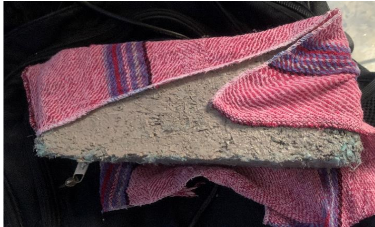
Figura 3.20 Remoción de exceso de agua por medio de trapo húmedo en ladrillo.
