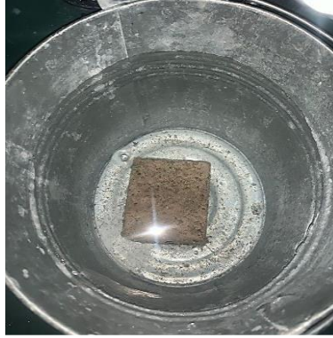
3.9b Prueba de absorción total en ladrillos.
