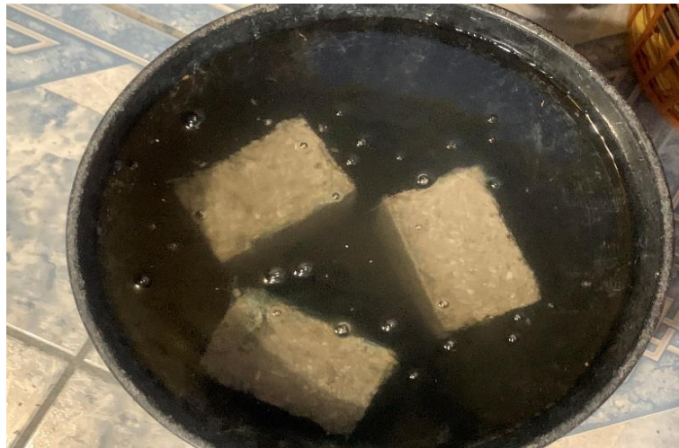
Figura 3.21 Lote de ladrillos sumergidos en agua para prueba de absorción total.
