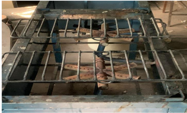
Figura 3.23 Dispositivo utilizado para prueba de resistencia al fuego en ladrillos.
