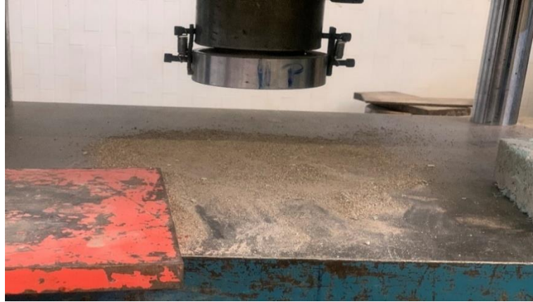
Figura 3.16 Arena fina colocada sobre la base de la maquina universal.
