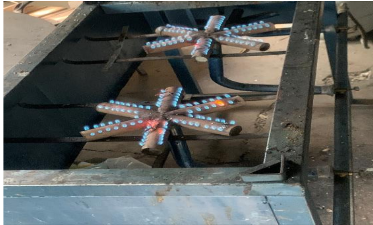
Figura 3.24 Encendido y calibrado de dispositivo de calor utilizado en prueba de resistencia al fuego en ladrillos.
