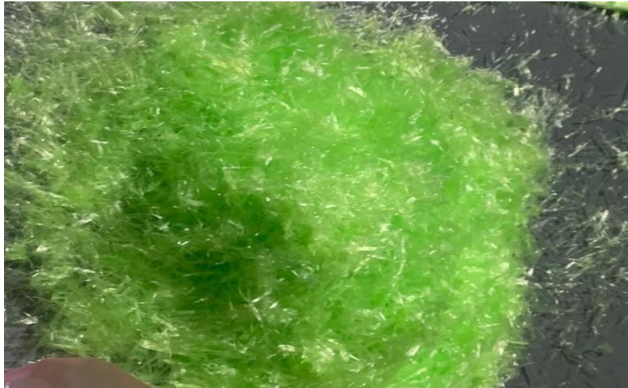
Figura 3.5 LDPE desmenuzado en diferentes tamaños de partículas.
