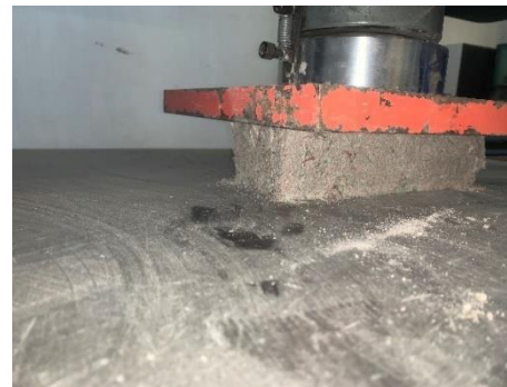
Figura 3.17b Especimen colocado sobre la maquina universal siendo ensayado.
