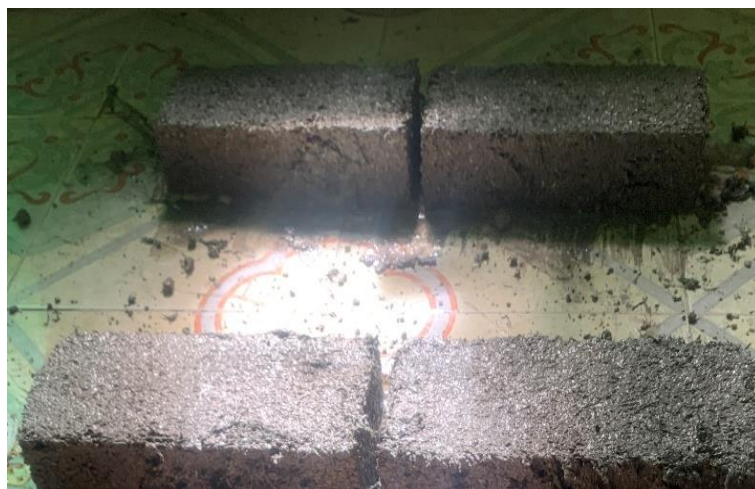
Figura 3.14 Descimbrado de tabiques.
