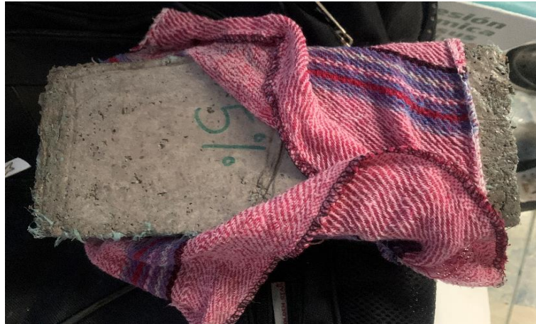
Figura 3.22 Secado de ladrillo con franela húmeda después de estar sumergido durante 24 horas.
