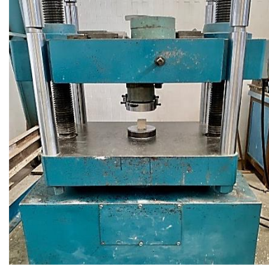
3.9c Ensayo a la compresión en mini bloques.
