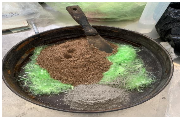
Figura 3.7 Diseño de mezcla de prototipos de mini bloques de concreto y LDPE.
