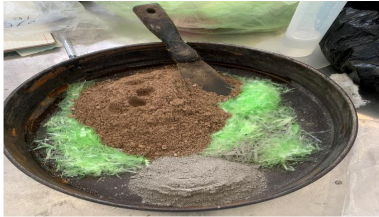
Figura 3.11 Mezcla de LDPE, arena y cemento Portland.
