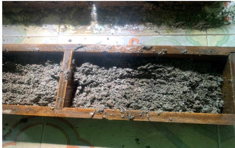
Figura 3.13 Mezcla incorporada en molde empleado para la elaboración de ladrillos.
