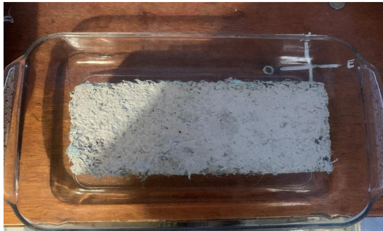
Figura 3.19 Espécimen colocado en recipiente con agua para prueba de absorción inicial.
