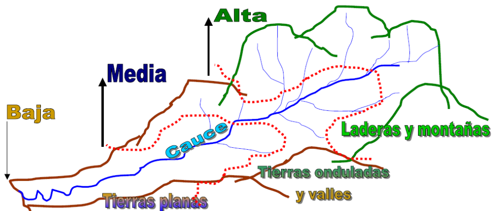
Figura 2.- Partes de una cuenca hidrográfica. Fuente: (Faustino et. al, 2006)
