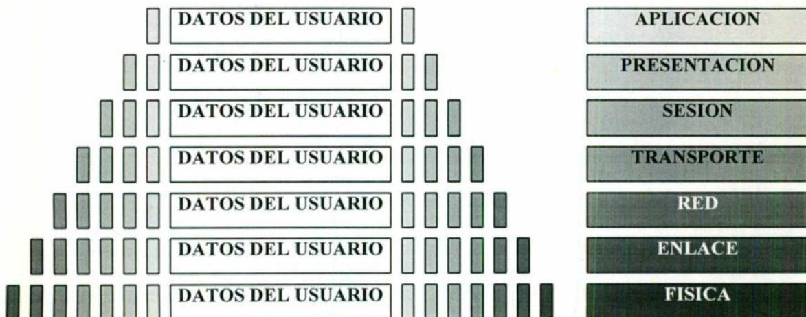
**Figura 10.-** Encapsulamiento en el modelo OSI
