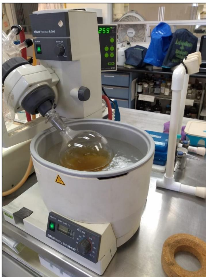
*Figura 11. Extracción de la esencia aromática en rotavapor del concentrado S.*
