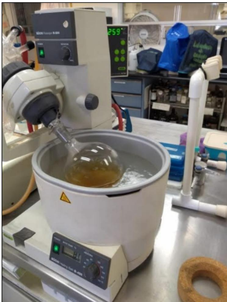
*Figura 15. Extracción en rotavapor del concentrado de canela en polvo a 80°C.*
