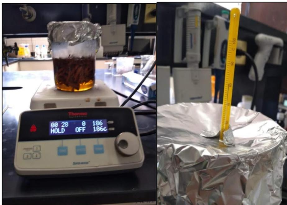
Figura 13. Proceso de decocción con la canela en polvo y la corteza de canela a 80°C.
