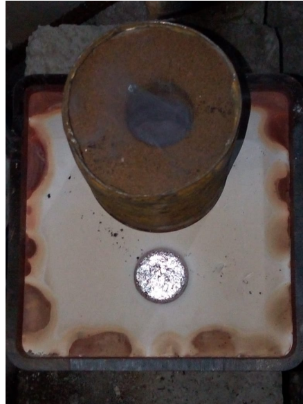
Figura 3.25: Vertido del aluminio dentro del molde.
