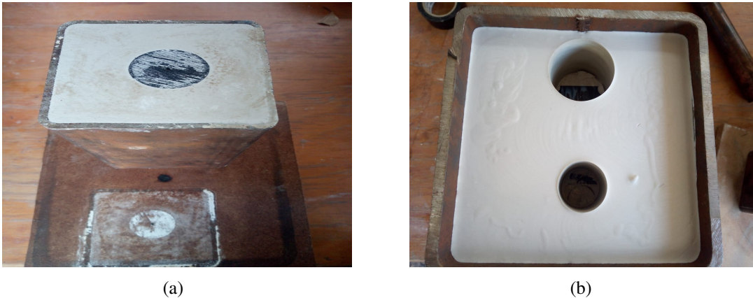
Figura 3.20: (a) Molde de cerámico y (b) tapa del molde.
