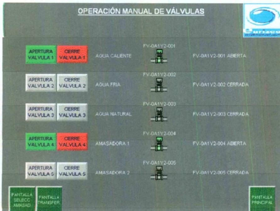
Figura 3.29 Pantalla "Operación manual de válvulas".
