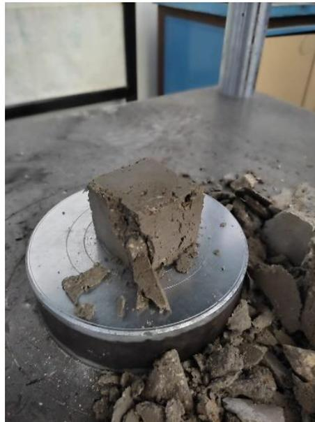
*Figura 49. Probeta de la muestra #1 llevada a su falla.*
