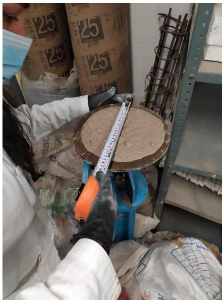
*Figura 46. Toma de medidas del diámetro final para la fluidez.*
