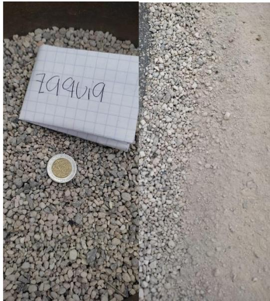
*Figura 42. Muestra del banco Zaquia antes y después del ensaye.*
