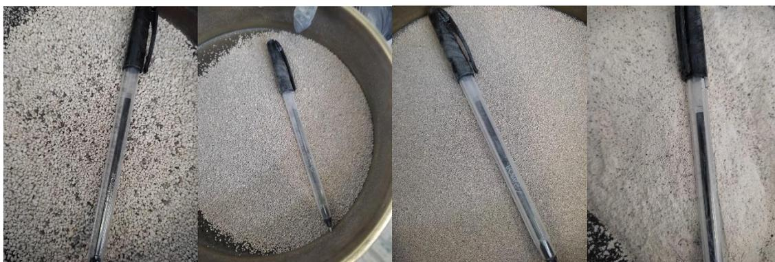
*Figura 32. Material retenido del banco Zaquia en las mallas N°10, N°20, N°40 y N°60.*
