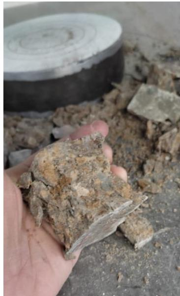
*Figura 52. Probeta de la muestra #2 llevada a su falla.*
