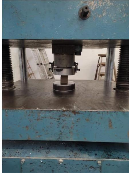
Figura 47. Ensaye a compresión de las muestras de mortero con Tepetate.
