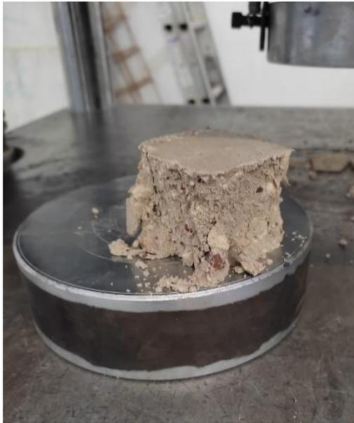
*Figura 55. Probeta de la muestra #3 llevada a su falla.*
