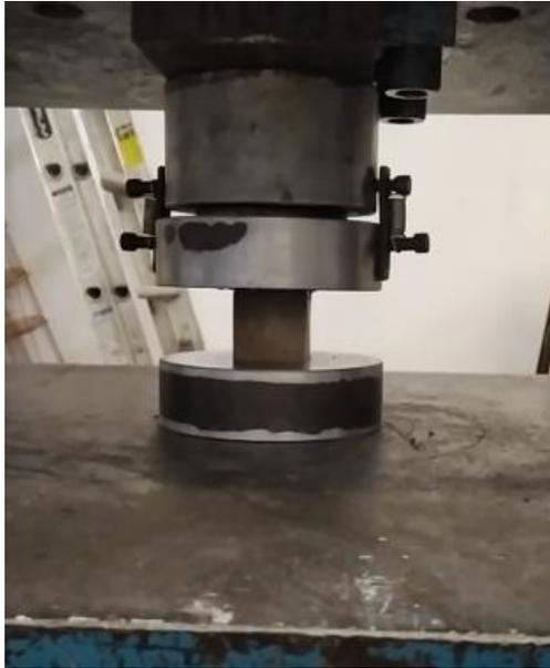
*Figura 15. Ensayo de la resistencia a la compresión de las probetas en la maquina Universal.*
