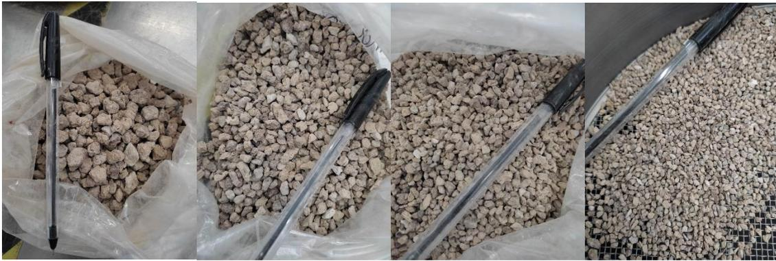
Figura 22. Material retenido del banco Tlacote en las mallas 1/4", N°4, N°6 y N°8.
