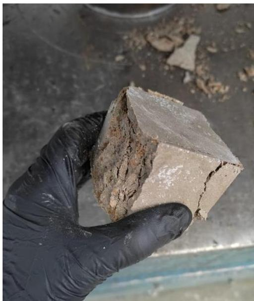
Figura 68. Probeta de la muestra #10 llevada a su falla.
