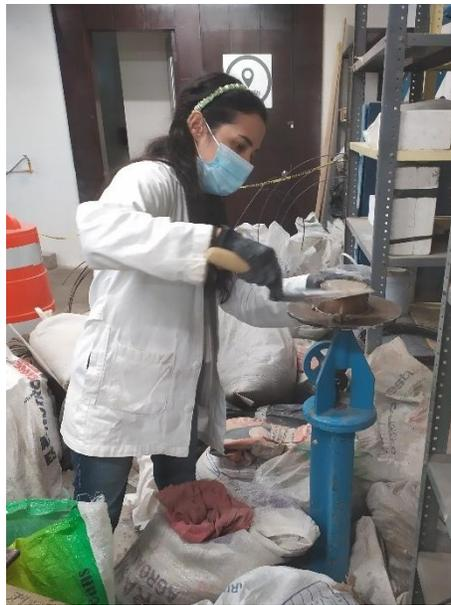
*Figura 44. Finalización del llenado y enrase del cono trunco para la Fluidez.*
