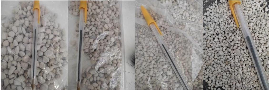
*Figura 28. Material retenido del banco Alpher en las mallas 1/4", N°4, N°6 y N°8.*
