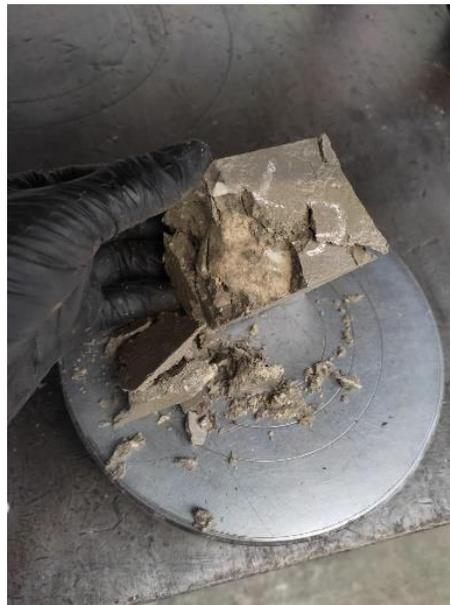
Figura 71. Probeta de la muestra #13 llevada a su falla.
