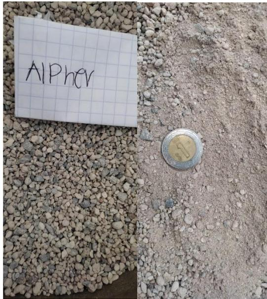
*Figura 41. Muestra del banco Alpher antes y después del ensaye.*
