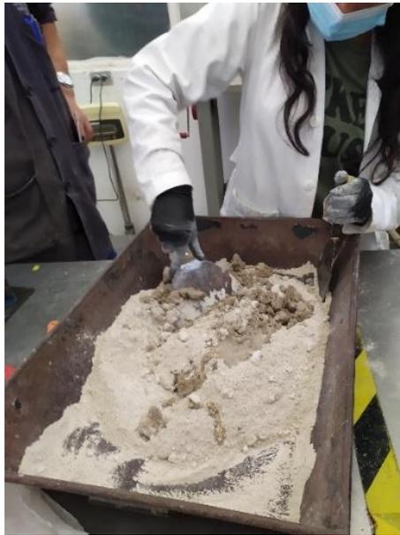
*Figura 9. Homogenización de los agregados para las probetas de mortero.*
