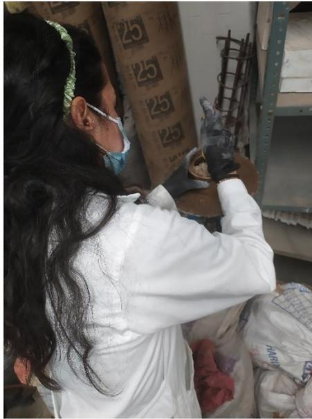
*Figura 43. Relleno y apisonamiento del cono tunco para la Fluidez.*
