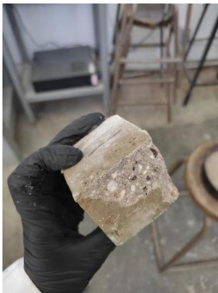
Figura 72. Probeta de la muestra #14 llevada a su falla.
