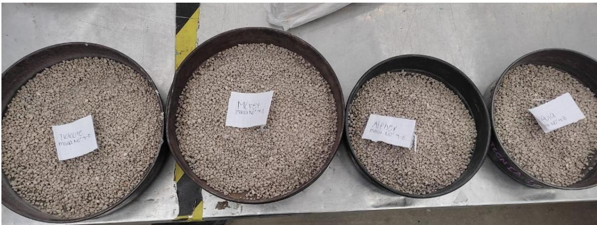
Figura 38. Muestras de los tepetates para el Desgaste de los ángeles.
