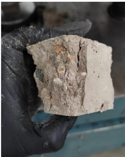
Figura 63. Probeta de la muestra #7 llevada a su falla.
