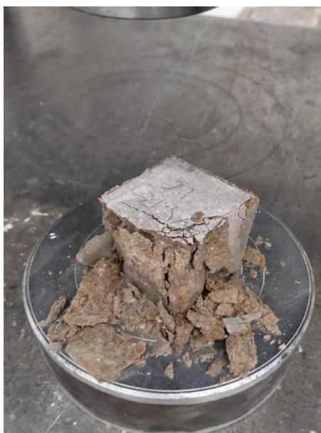
*Figura 62. Probeta de la muestra #6 llevada a su falla.*
