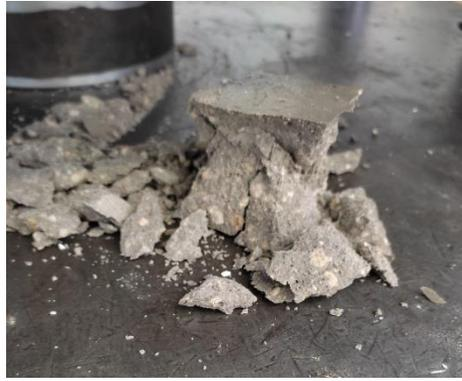
Figura 60. Probeta de la muestra #5 llevada a su falla.
