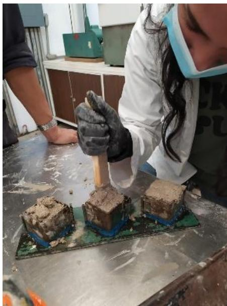
*Figura 13. Llenado de los moldes de mortero.*
