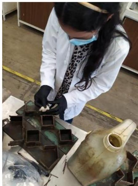
*Figura 12. Preparación de los moldes de mortero.*
