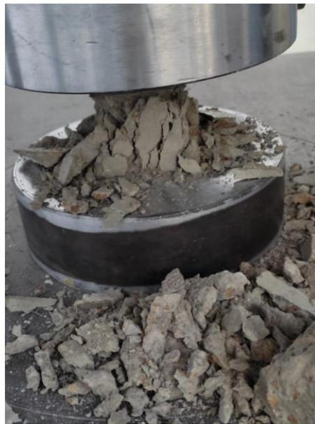
*Figura 58. Probeta de la muestra #4 llevada a su falla.*
