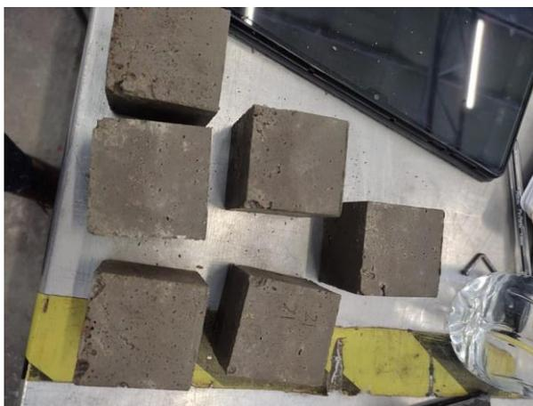
*Figura 14. Probetas de mortero a base de tepetate desmoldadas.*
