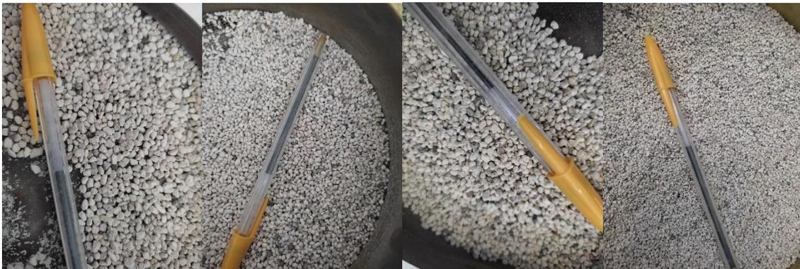
*Figura 29. Material retenido del banco Alpher en las mallas N°10, N°20, N°40 y N°60.*
