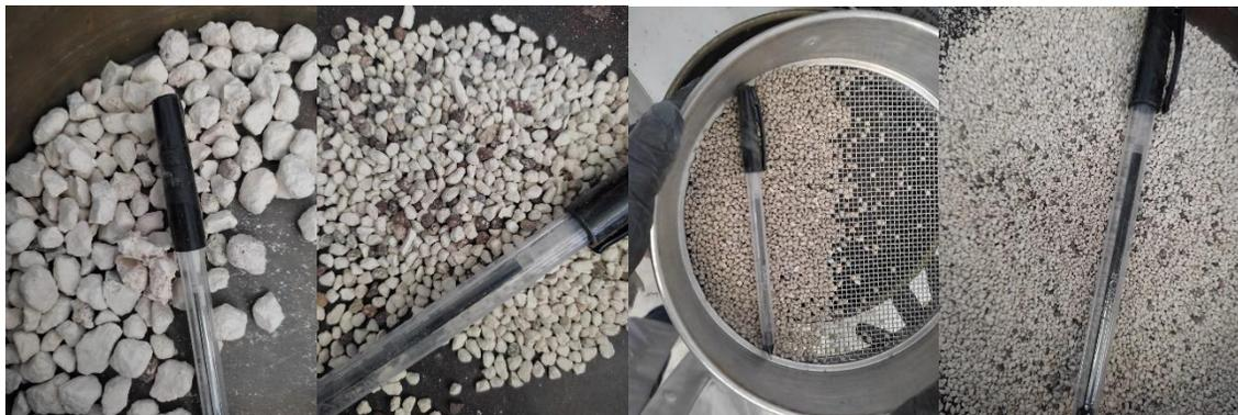
*Figura 31. Material retenido del banco Zaquia en las mallas 1/4", N°4, N°6 y N°8.*
