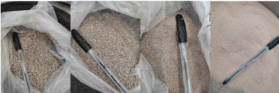
Figura 23. Material retenido del banco Tlacote en las mallas N°10, N°20, N°40 y N°60.
