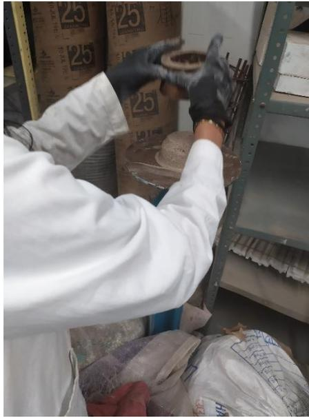
*Figura 45. Retiro del cono tunco para la medición del diámetro inicial.*
