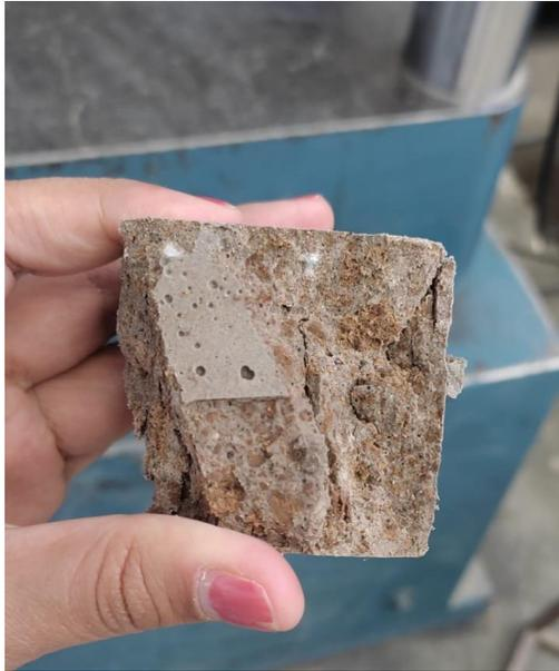
*Figura 65. Probeta de la muestra #8 llevada a su falla.*
