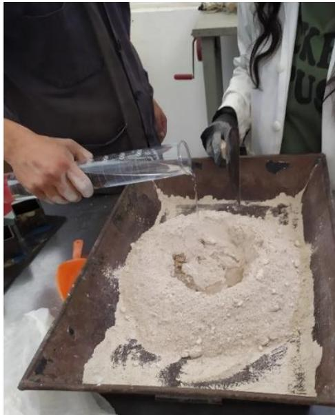
*Figura 10. Vertido del agua en la mezcla.*
