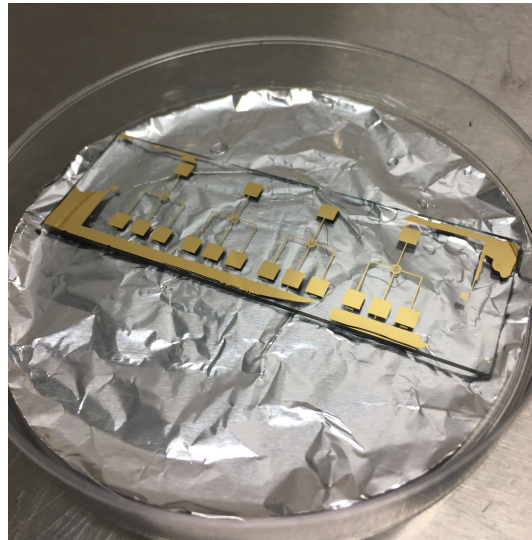
Figura 4.14: Microelectrodos interdigitados de oro fabricados sobre sustratos de vidrio mediante lift-off .
