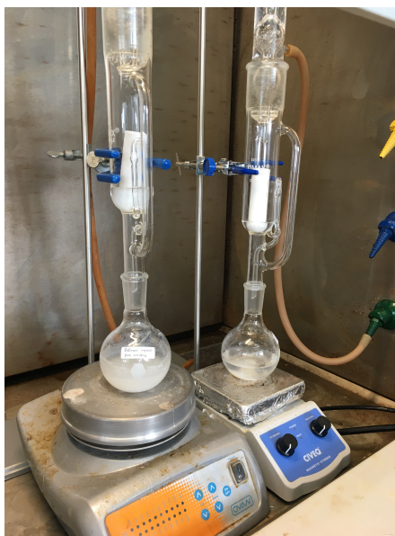
Figura 4.19: Fotografía de la implementación del sistema Soxhlet como método para la eliminación de la molécula plantilla.
