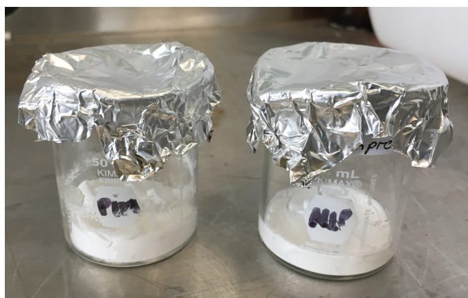
Figura 4.16: Fotografía del polímero impreso molecularmente (MIP) y polímero no impreso molecularmente (NIP) obtenidos en bloque sólido mediante síntesis acrílica no covalente.
