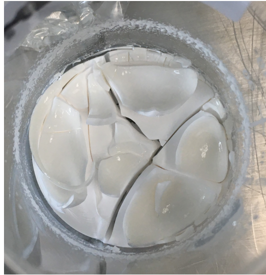
Figura 4.17: Fotografía de la apariencia física del polímero impreso molecularmente.
