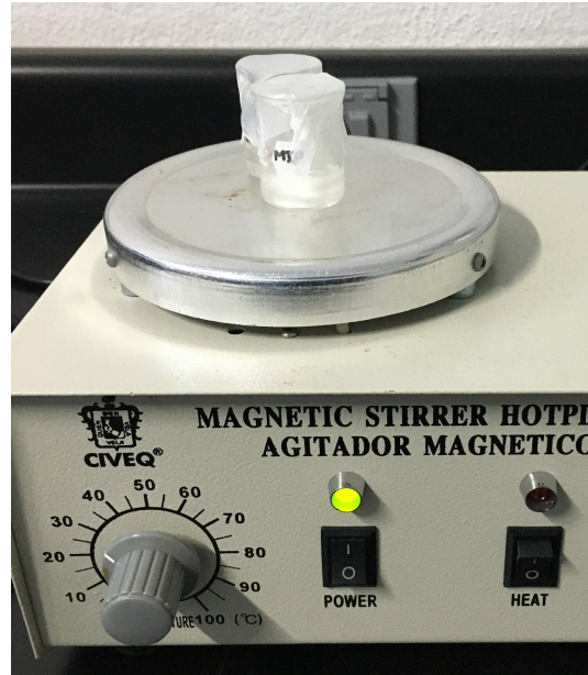
Figura 4.20: Fotografía durante la agitación de la mezcla como parte de la deposición por emulsión del MIP.
