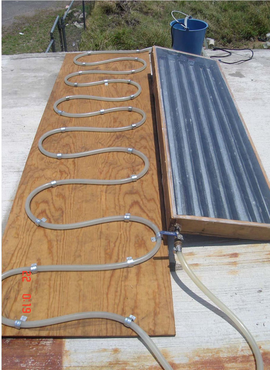
Figura 5.13. Calentador solar para el postratamiento de aguas residuales después del tratamiento primario.
