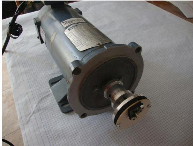
Figura 4-7. Montura del acelerómetro 1 en el motor de CD.
