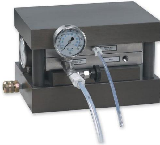
Figura 5.2 Unidad de separación por membrana SEPA CELL II, Osmonics utilizada para la separación y concentración de leche descremada.
