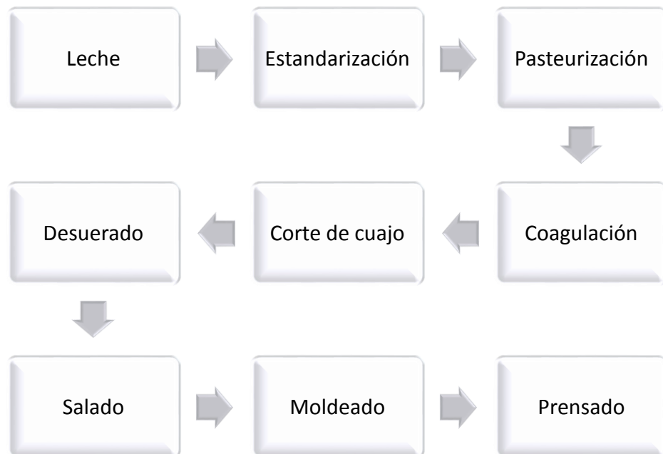
Figura 2.7 Diagrama de flujo de los principales pasos para la elaboración de queso (Fox y Cogan, 2000)
