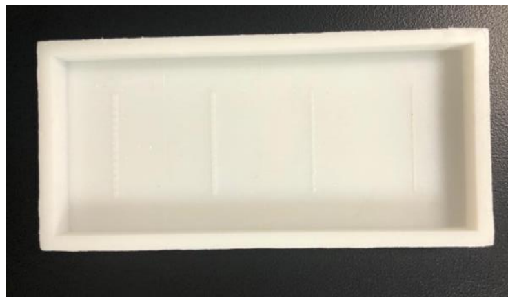
Figura 32.- Fotografía del molde obtenido mediante impresión 3D después de los tratamientos de curado.
