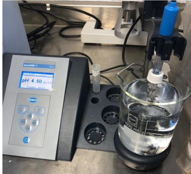
Figura 28.- Fotografía del potenciómetro HACH, SENSION TM utilizado para el ajuste de pH de las soluciones de sudor simulado.
