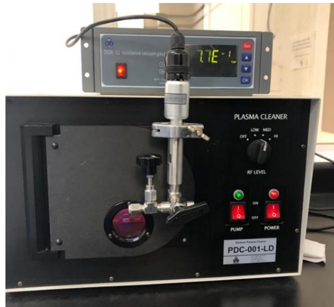
Figura 25.- Fotografía del equipo de limpieza por plasma donde se realiza la adherencia de la película con la tapa con canal microfluídico de PDMS (MTI CORPORATION, Medium Plasma Cleaner).
