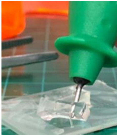
Figura 26.- Fotografía de la perforación de entrada y salida de fluido en el canal de PDMS.
