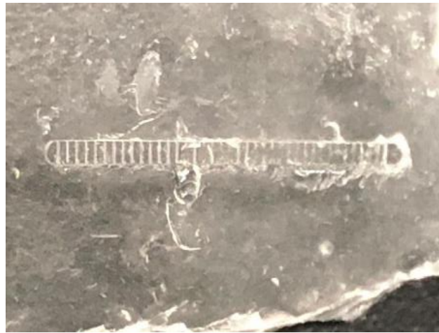
Figura 33.- Fotografía del canal microfluídico que no ha polimerizado completamente.
