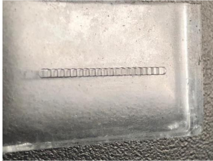
Figura 34.- Fotografía del canal microfluídico de PDMS obtenido del molde que ha recibido un tratamiento térmico.
