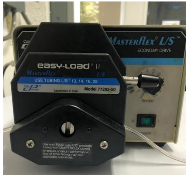
Figura 37.- Fotografía de la bomba peristáltica (COLE PALMER, MASTERFLEX® L/S ECONOMY DRIVE) utilizada para la inyección de las soluciones en el sistema microfluídico.
