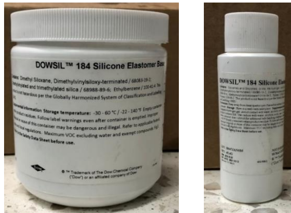
Figura 17.- Fotografía de los reactivos utilizados para la preparación del PDMS.
