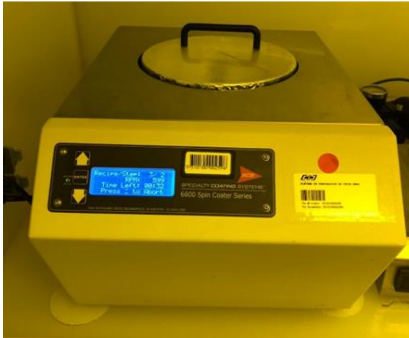
Figura 22.- Fotografía del equipo de spin coating (SPECIALTY COATING SYSTEMS, 6800 Spin Coater Series).
