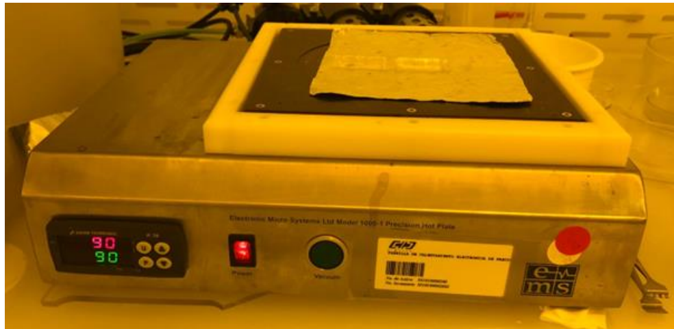
Figura 23.- Fotografía del plato de calentamiento para tratamiento térmico del PDMS depositado sobre el vidrio.
