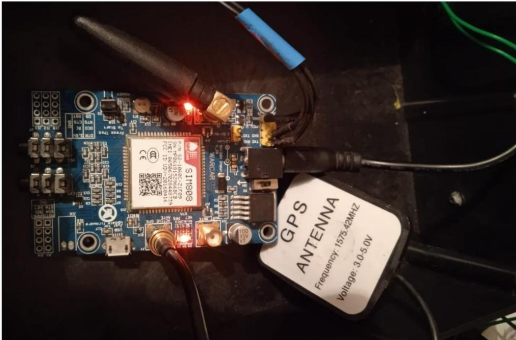
Figura 98. Conexión de antenas con módulo SIM808.
