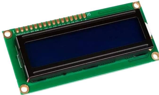
Figura 22. Pantalla LCD 16x2.
