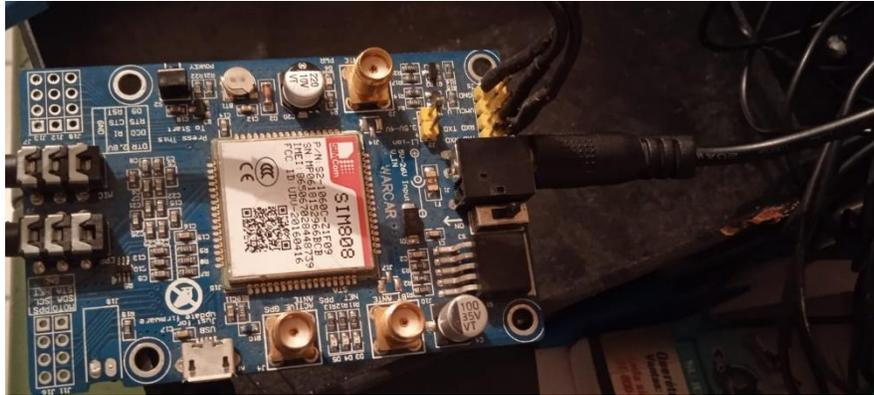
Figura 90. Conexión física de alimentación al módulo SIM808.
