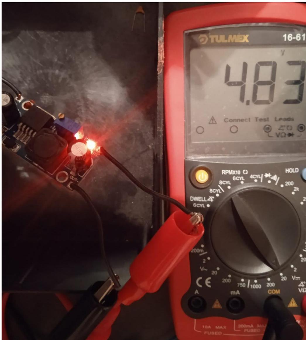
Figura 84. Comprobación de salida de voltaje del módulo LM2596 con 3000rpm
