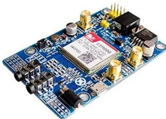
Figura 21. Vista lateral módulo SIM808.
