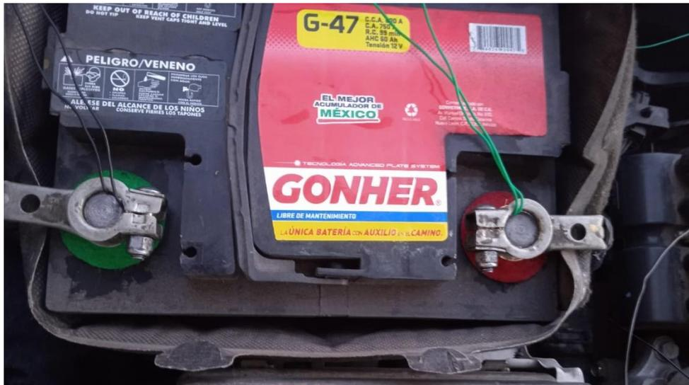
Figura 53. Conexión del sistema embebido a la alimentación.
