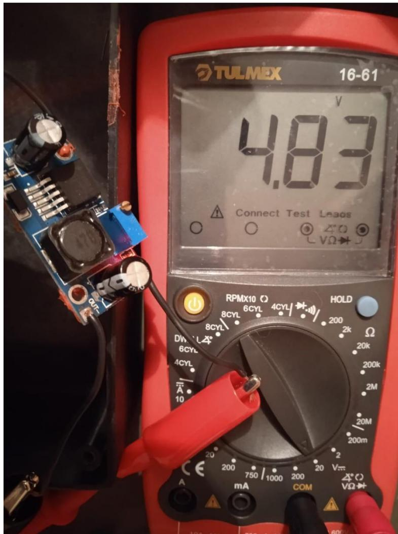
Figura 83. Calibración del módulo LM2596.
