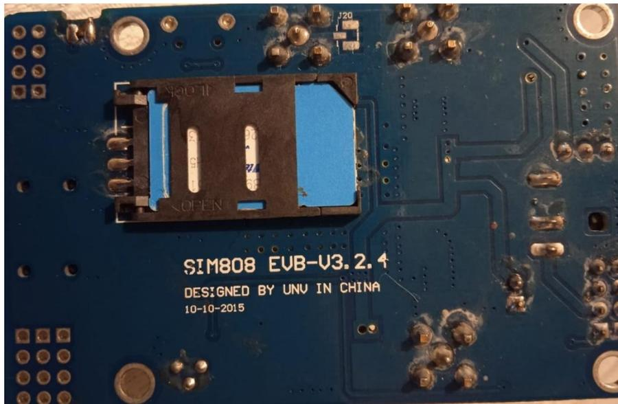
Figura 31. Instalación de tarjeta SIM con módulo SIM808.
