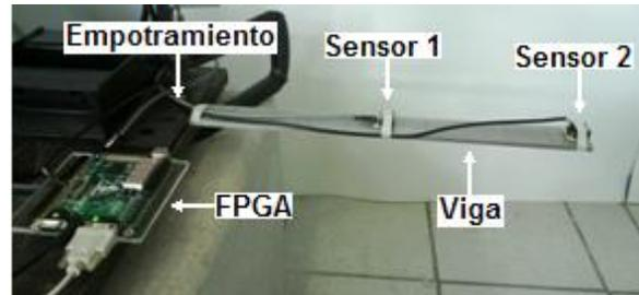
Figura 6. Modelo experimental de la viga.
