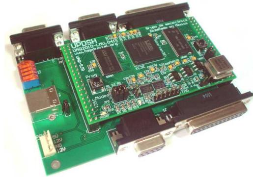
Figura (3.16) Tarjeta de control PLCUAQ8x16.
