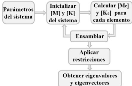
Figura 4. Diagrama bloques para el cálculo FEM.
