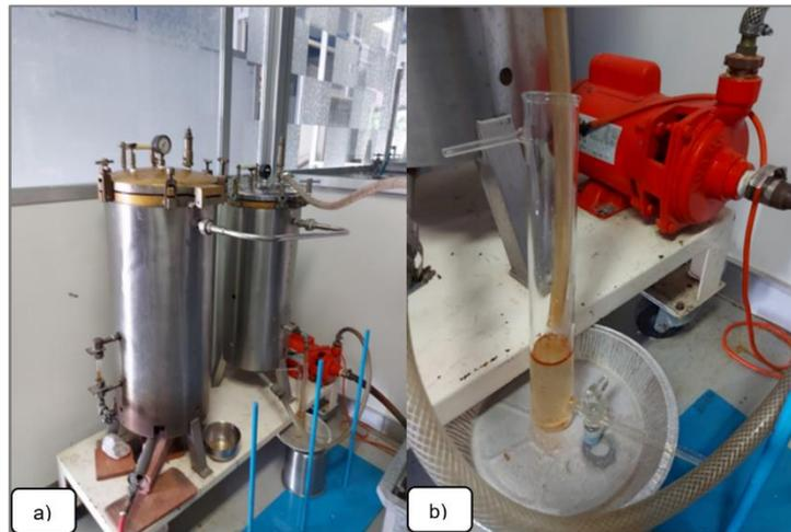
Figura 16. a) Autoclave adaptado, b) Aceites esenciales extraídos.
