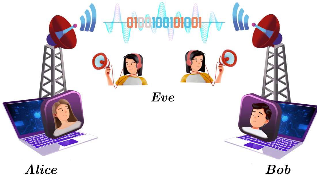
Figura 2.1: Representación de un sistema de comunicación clásico. La PC del lado izquierdo representa al emisor “Alice” y a la derecha se representa al receptor “Bob”. Ambos transmiten la información encriptada por medio de un canal de transmisión de ondas en el espacio libre. Este es un canal inseguro, en el que “Eve”, puede obtener la información sin que los interlocutores se den cuenta de la invasión (Elaboración propia).
