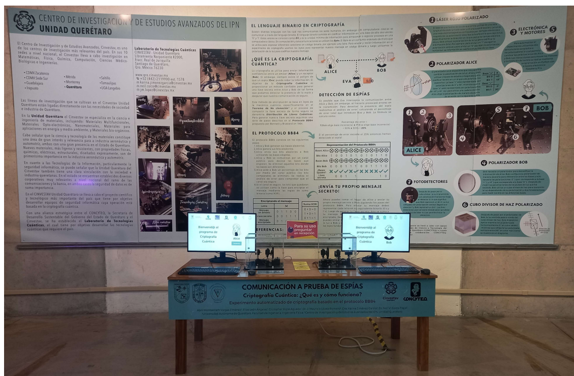
Figura 4.19: Prototipo experimental automatizado de criptografía cuántica final con todas las componentes ópticas y electrónicas, el sistema de protección y carteles científicos para su explicación.
