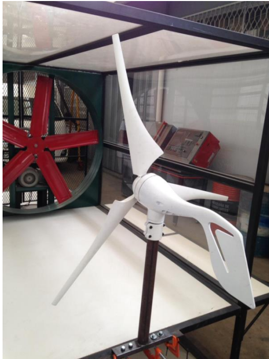
Figura 29.- Aerogenerador y base colocados en el túnel de viento
