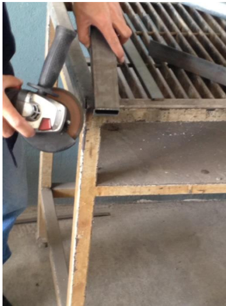
Figura 22. Corte y eliminación de rebaba de las piezas
