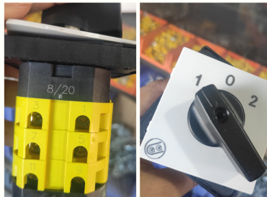
Figura 4.3. Conmutador (autoría propia).
