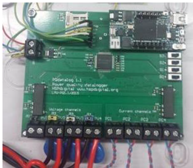
Figura 2.3 Tarjeta de adquisición de datos PQUAQ (autoría propia).
