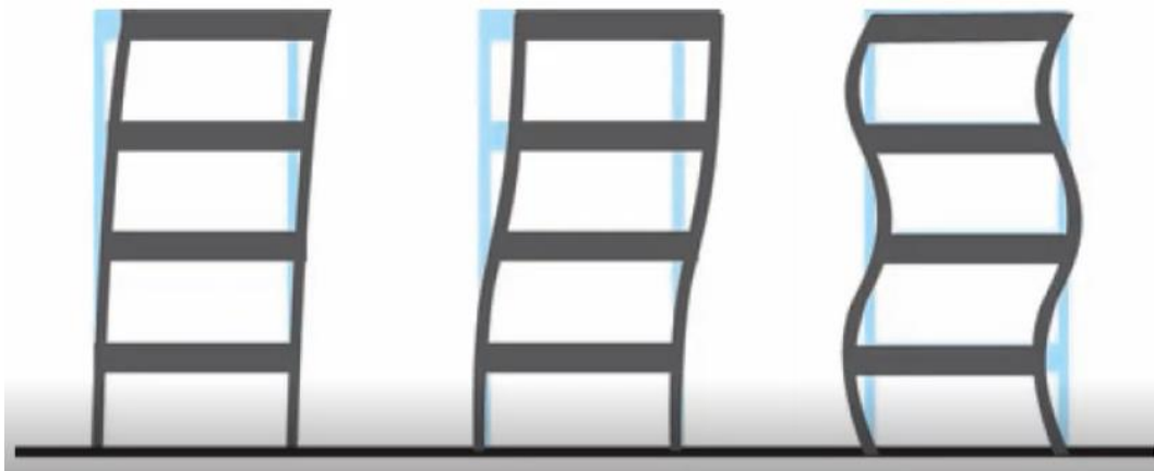
Figura 2.7. a) Primer modo, b) Segundo modo y c) Tercer modo de vibrar (Arnold, 2006)
