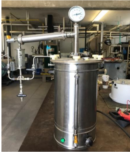
Figura 5.7 Alambique con aislante térmico, condensador y vaso florentino a nivel piloto para destilación con arrastre con vapor. Imagen obtenida de Huerta (2009).
