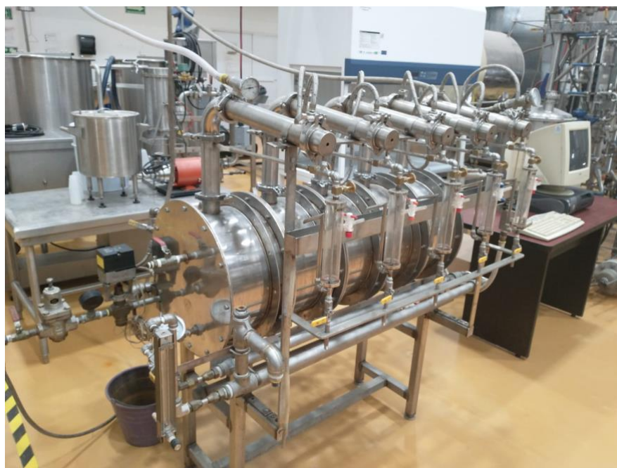
Figura 5.6 Equipo de destilación en continuo en CIATEJ. Imagen obtenida de (Padilla et al , 2007).
