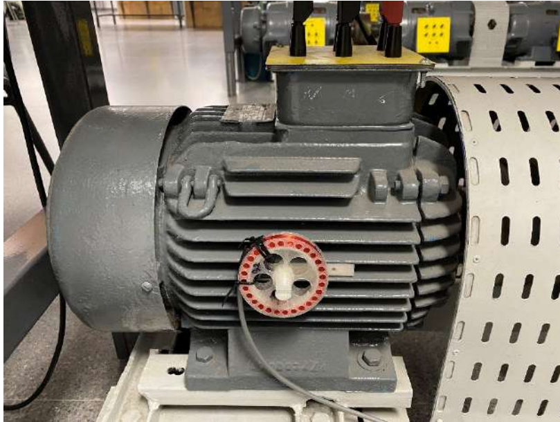
Figura 64. Segundo motor probado durante los experimentos (motor 2): 7,5 kW, 2 pares de polos
