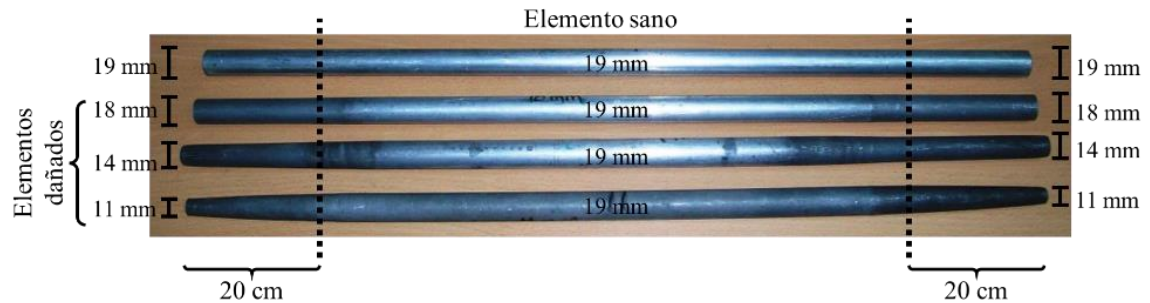
Figura 3.3: Ejemplo de los elementos sano y dañados usados en la investigación.
