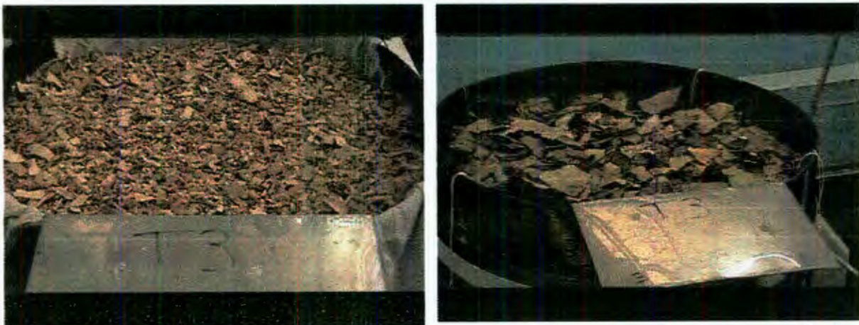
Figura 3.1 Materiales colocados en el área de estudio justo antes de iniciar la simulación bajo la lluvia (izq. Aserrín, der. Hojas de álamo).
