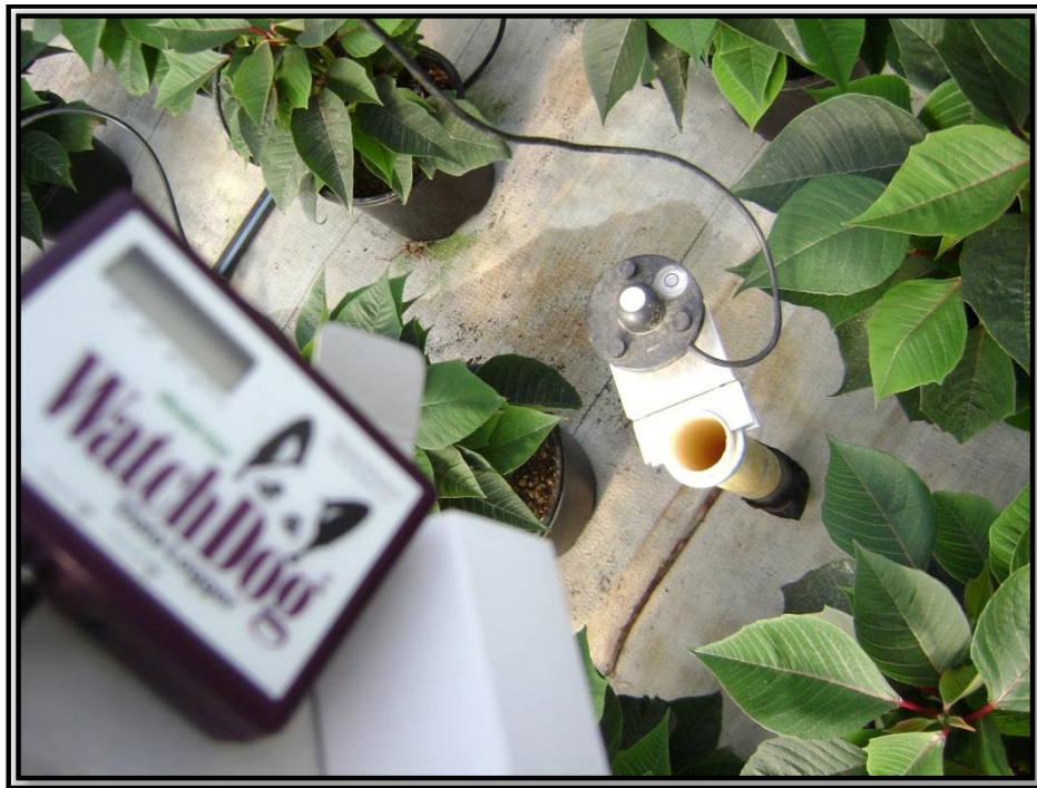
Figura 3.1.2.c Sensores de temperatura, humedad relativa y radiación solar.
