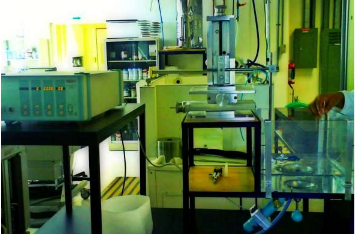
Figura 6. Fotografía que muestra el generador de ondas de choque Piezoson 100 plus con sus diferentes componentes.
