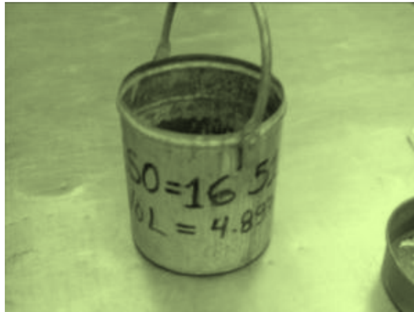
Fig. 10 Recipiente para el cálculo de peso volumétrico de la arena
