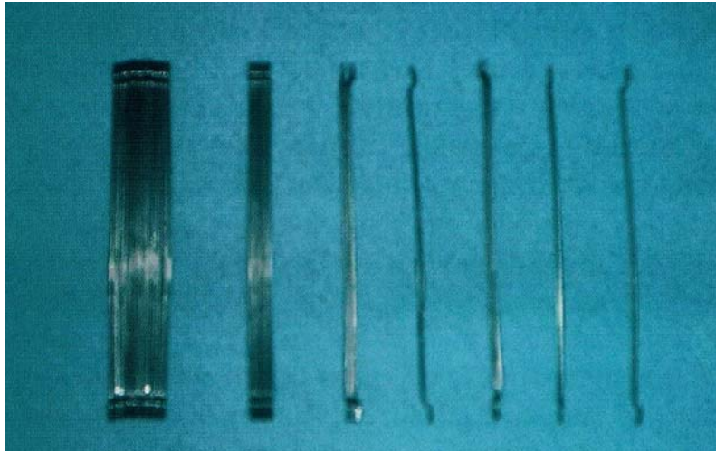
Fig. 2 Las fibras de acero con extremos conformados se pegan para formar haces que facilitan el manejo y el mezclado, los haces se separan en fibras individuales.
