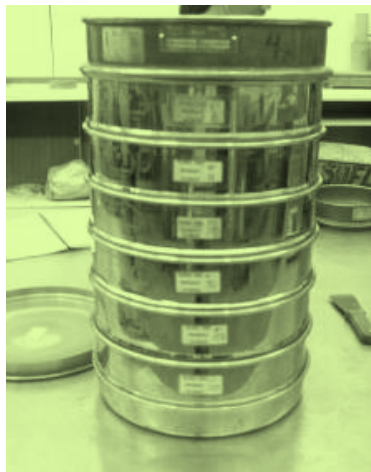
Fig. 15 Tamices para la granulometría de la arena
