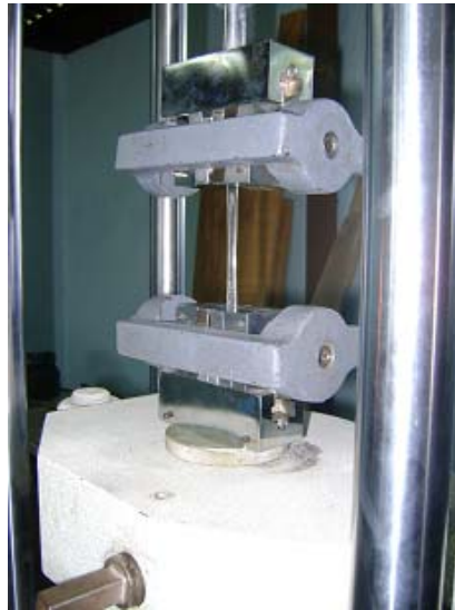
Fig. 16 Prueba de tensión al PET
