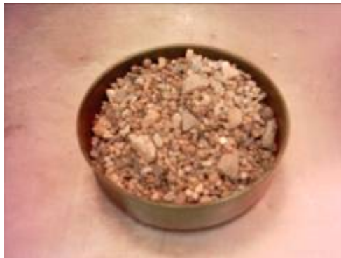
Fig. 8 Cantidad de grava obtenida de una muestra de arenilla
