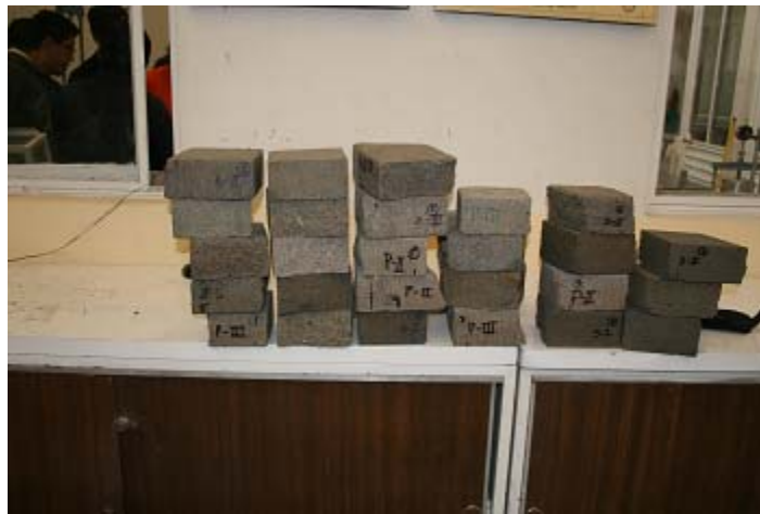
Fig. 23 Determinación de pesos después de 24 horas de inmersión.
