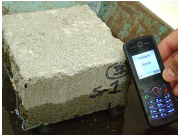
Fig. 24 Prueba de absorción inicial.
