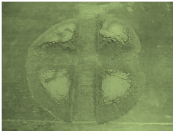
Fig. 11 Cuarteo de la arena para elegir una muestra representativa de la misma
