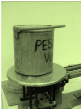
Fig. 12 Recipiente de peso volumétrico colocado en la báscula para obtener el peso
