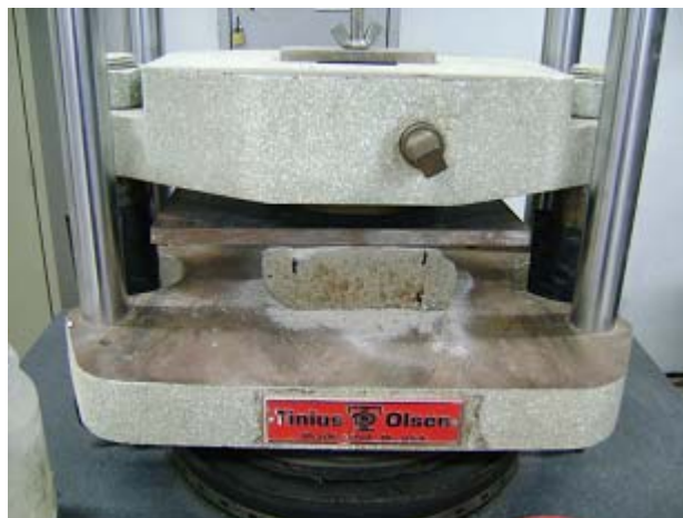
Fig. 25 Prueba de resistencia a la compresión.
