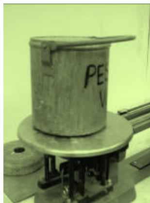
Fig. 14 Recipiente utilizado para el peso volumétrico
