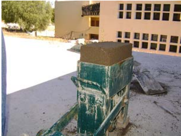
Fig. 19 Elaboración de tabiques por compresión
