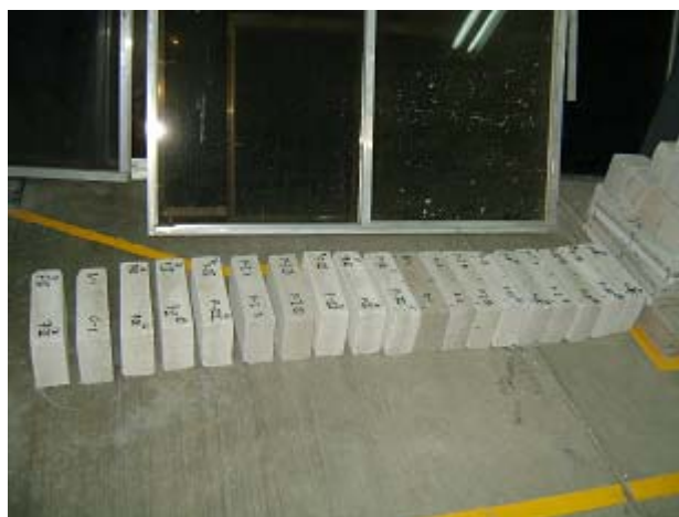
Fig. 27. Tabiques de concreto comprimido
