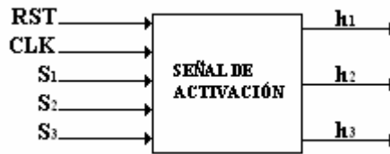
Figura 4.8.- Bloque lógico de la señal de activación
