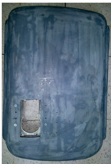
Figura 4.7: Parte trasera de la carcasa de fibra de vidrio del Panel de Control.
