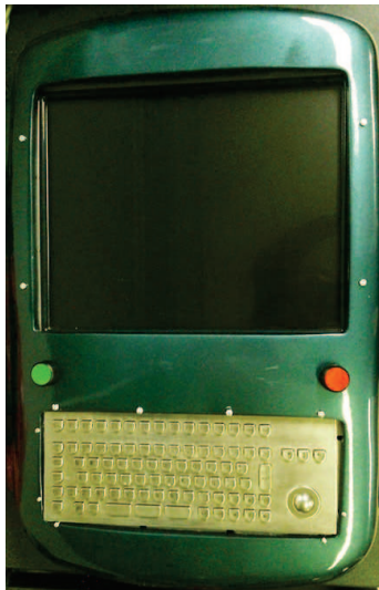
Figura 4.10: Ensamblaje de elementos en la carcasa delantera del panel de control.
