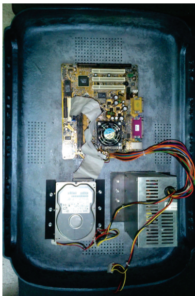
Figura 4.9: Ensamblaje de elementos en la carcasa trasera del panel de control.
