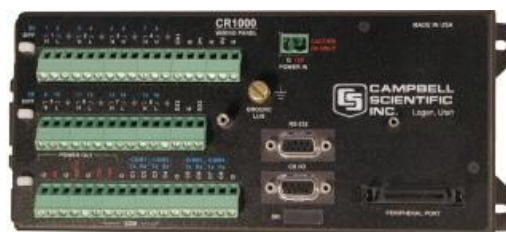
Figura 1 Datalogger marca Campbell Scientific (Cortesía Campbell Scientific)
