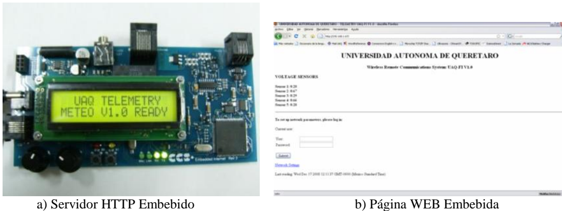
Figura 3. Servidor HTTP embebido basado en un MCU de alto rendimiento PIC18F6722 y Página Web.
