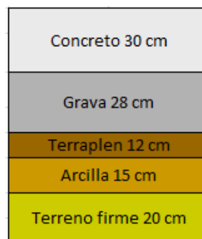
FIGURA 17.- Sección de pavimento existente (Gómez, 2013).
