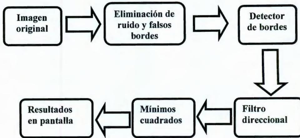
**Figura 3-8 Diagrama de flujo del software**
