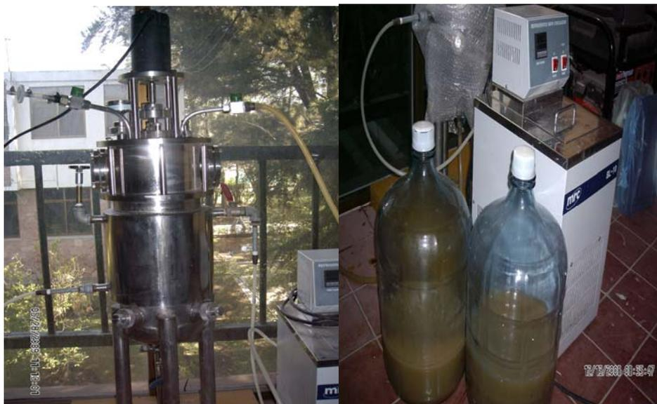
**Figura 5.3.** Biorreactor de tanque agitado. **Figura 5.4** Cultivo sumergido de *Flavobacterium sp.* ATCC 21588.
