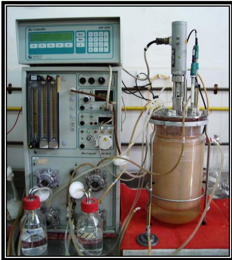
Figura 9. Biorreactor de tanque agitado utilizado durante los experimentos.
