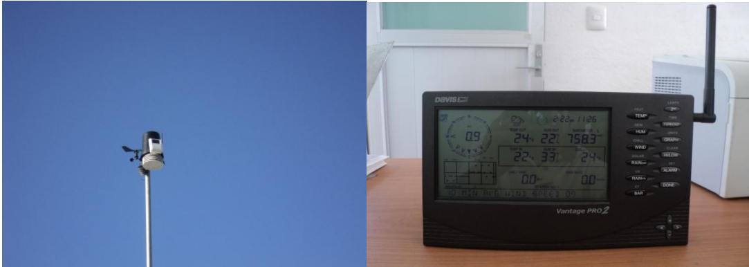
Figura 3.8 Estación meteorológica Davis Pro2.
