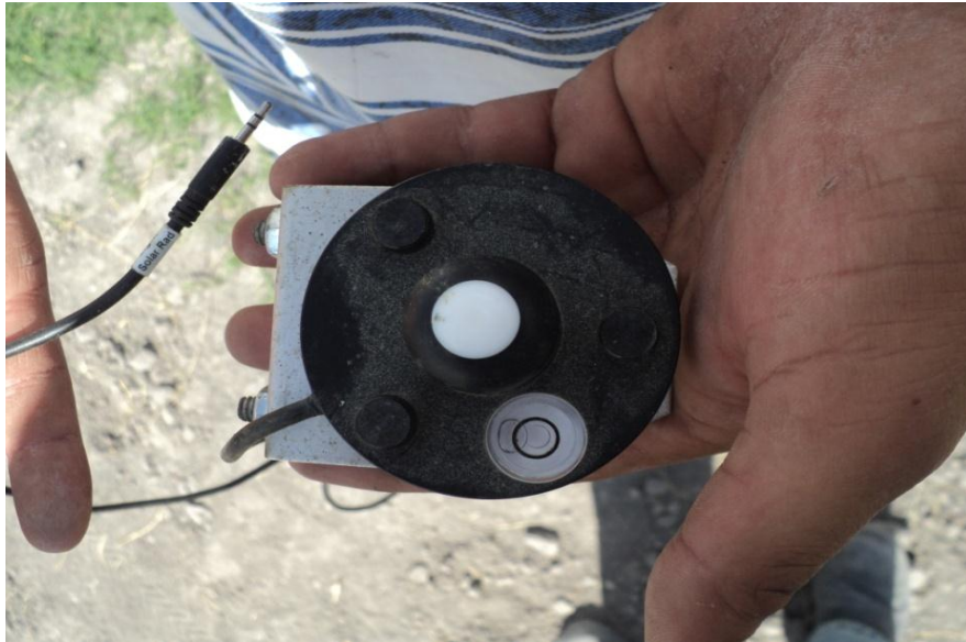
Figura 3.7 Sensor de radiación PAR.
