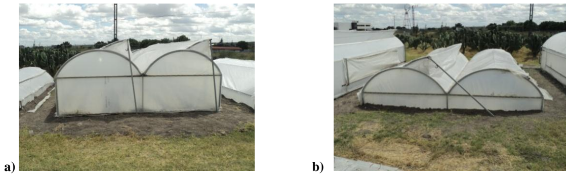
Figura 2.3 a) Prototipo a nivel del suelo. b) Prototipo semi-enterrado.
