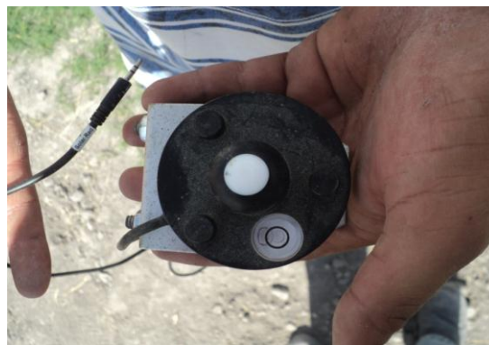
Figura 2.5 Sensor de radiación PAR.
