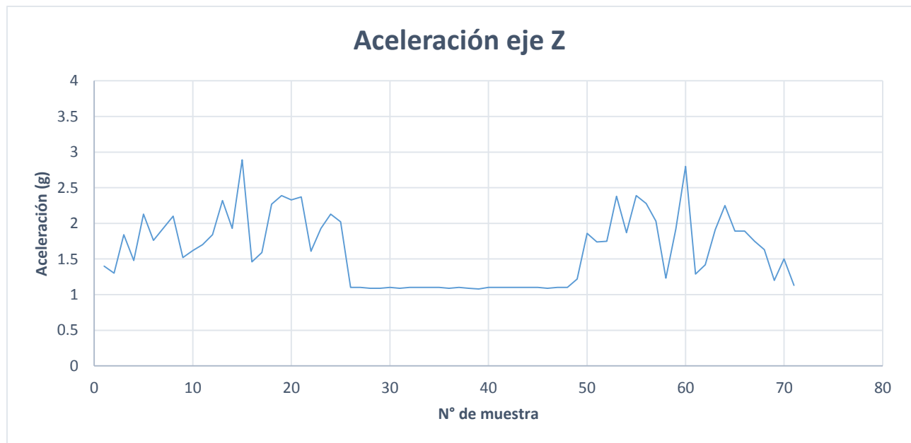
Figura 93 Aceleración obtenida del autobús en el eje Z
