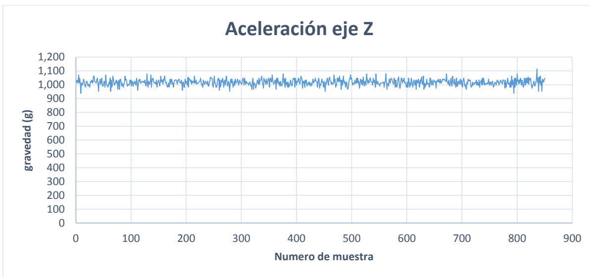
Figura 25 Medidas aceleración eje Z en reposo
