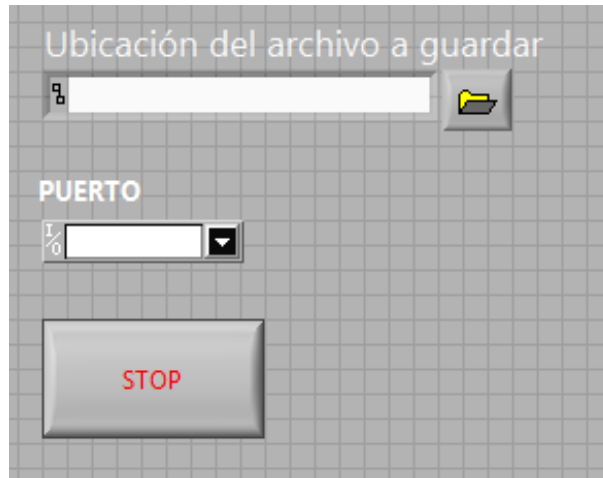
Figura 17 Programa para la recepción de datos vía RS232
