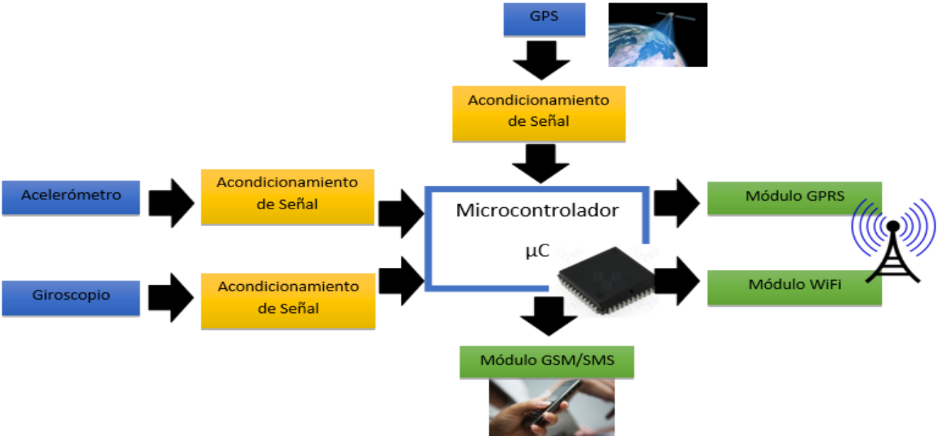
Figura 12 Diagrama a bloques de los componentes del dispositivo
