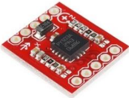
Figura 27 Modulo LPY503AL obtenido de www.sparkfun.com
