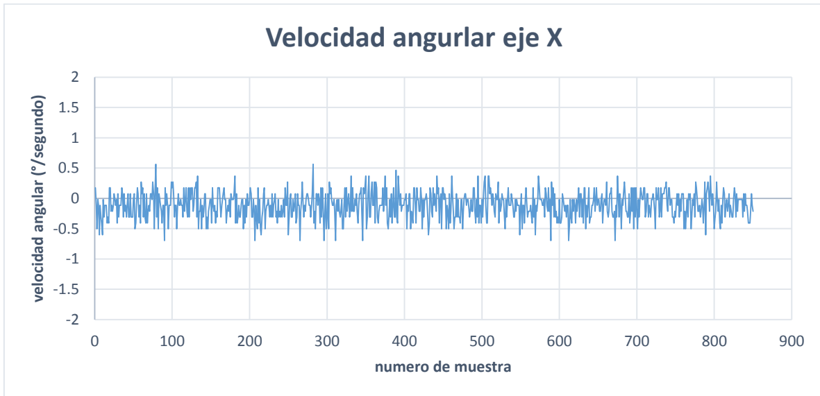
Figura 30 Grafica de medidas velocidad angular eje X en reposo
