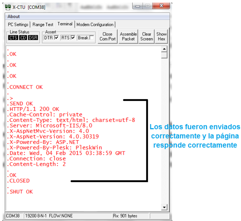
Figura 44 Respuesta del módulo a los comandos para el envío de datos
