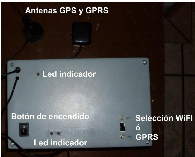
Figura 63 Dispositivo completo en la carcasa
