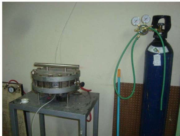
Figura 3.8. Izquierda: cámara de presión con muestras de suelo no saturado en su interior, Derecha: Tanque a presión con nitrógeno en su interior.
