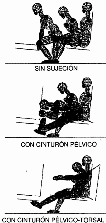
Figura 3.4. Movimientos de un ocupante sentado en el interior de un tren que choca.
