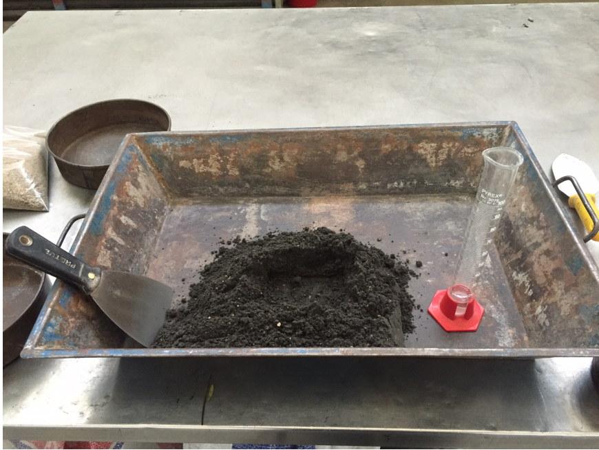
FIGURA 4.8: Mezcla de puzolana y cal.
