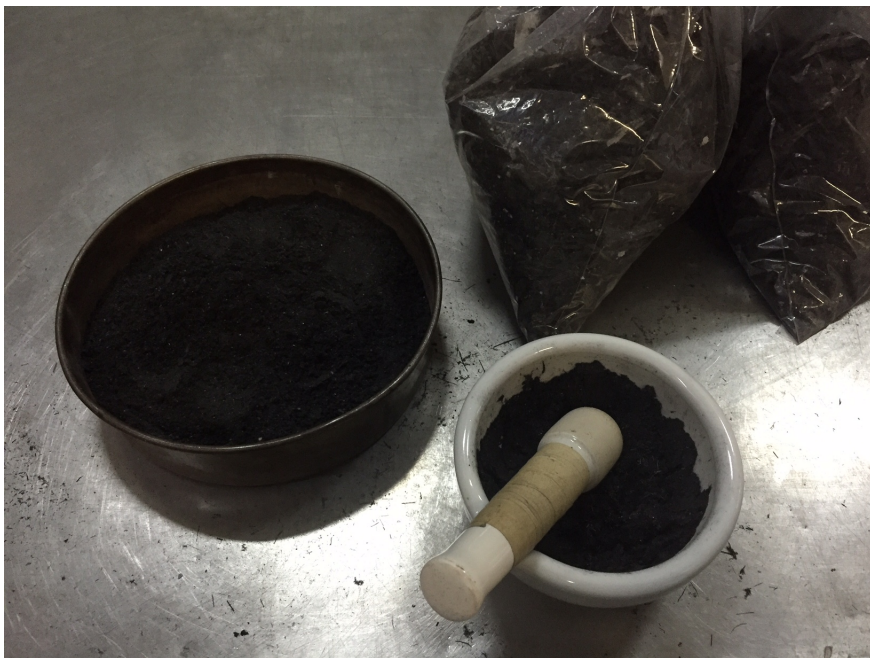
FIGURA 4.2: Ceniza molida en mortero.
