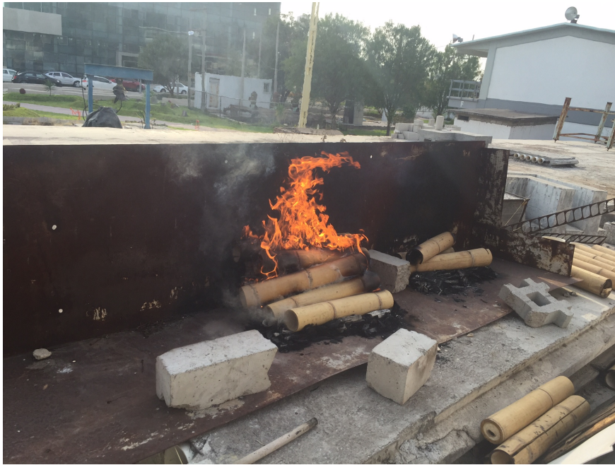
FIGURA 4.1: Quema controlada del tallo de bambú.
