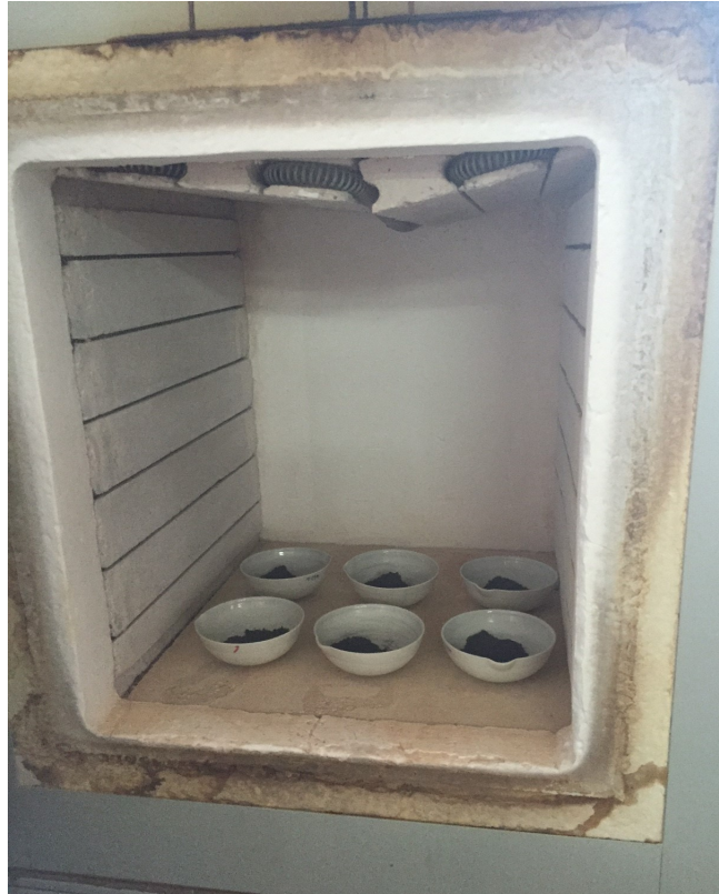
FIGURA 4.3: Ceniza calcinada en mufla.
