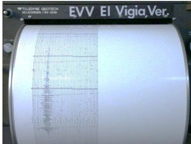
Figura 2.4 Sistema de registro sobre papel (Fotografía tomada del SSN).
