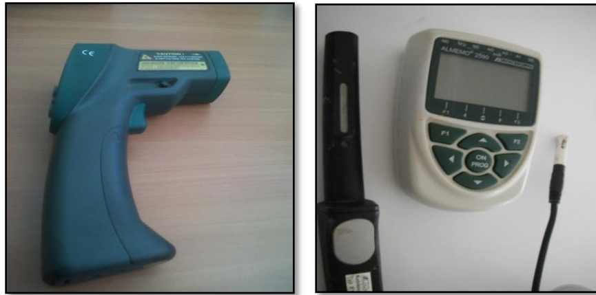
Figura 21. Medidor laser de radiación Steren, y Dataloger ALMEMO2590.
