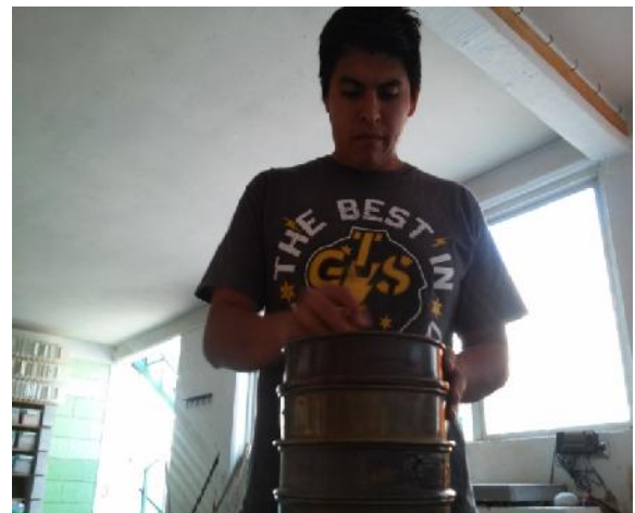
Figura 3-10 Cuarteo y posterior reducción del mismo. Como se puede observar se realizó también el respectivo análisis granulométrico del mismo.
