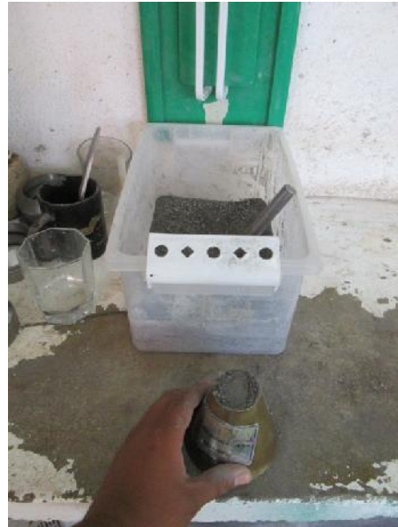
Figura 3-12 Cono para la determinación de la absorción.
