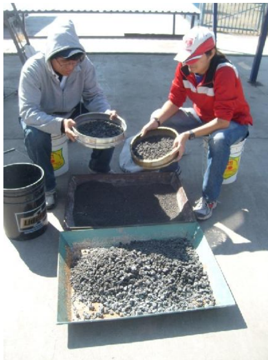
Figura 3-9 Cribado de material, aquí se pidió ayuda a compañeros de la carrera para poder lograr estas actividades.
