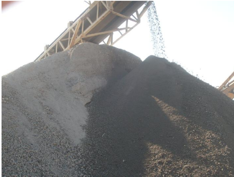
Figura 3-5 Depósito de escoria una vez que ha sido cribada.
