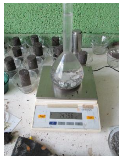
Figura 3-14 Matraz aforado para la determinación de la densidad de solidos de la arena.
