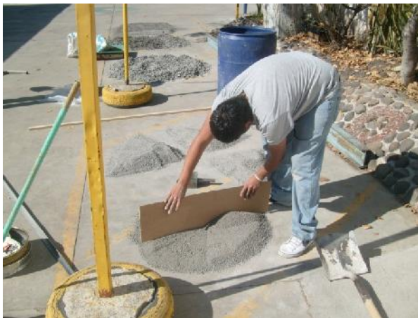
Figura 3-10 Cuarteo y posterior reducción del mismo. Como se puede observar se realizó también el respectivo análisis granulométrico del mismo.
