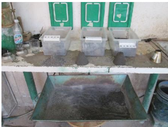
Figura 3-13 Se puede observar la tonalidad más oscura al aumentar el contenido de agua.
