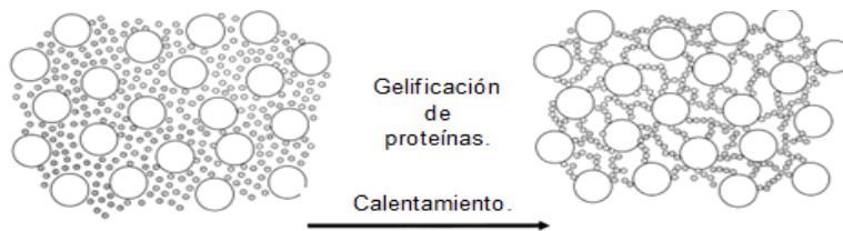
Figura 10. Ilustración esquemática de la formación de gel con una proteína globular en una suspensión de polvo cerámico, adaptado de (Jiding, 2001).
