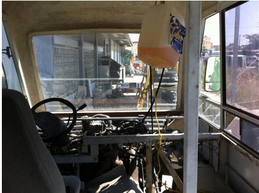
Figura 3.2.2 Bidón de combustible suspendido y conectado a las mangueras.
