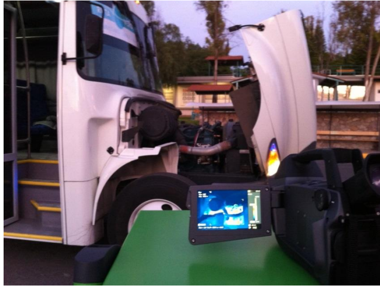
Figura 3.3.1 Posición de la cámara termográfica IR para el análisis.
