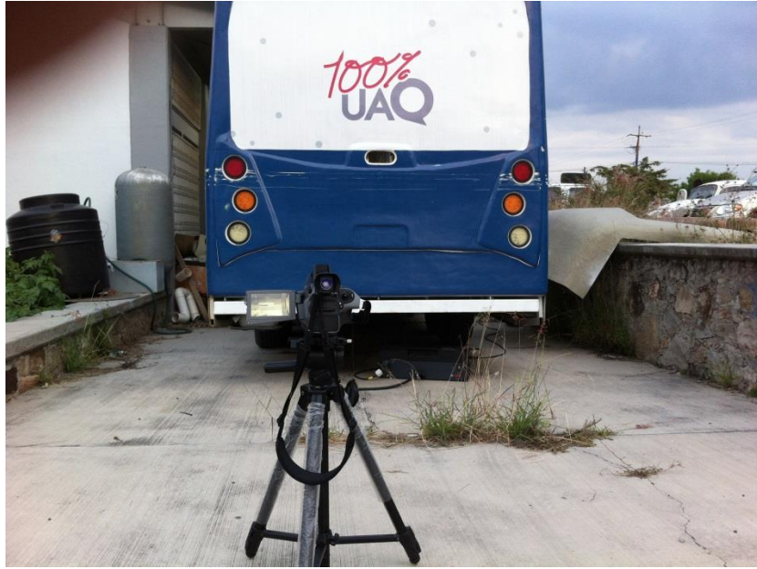
Figura 3.2.22 Análisis de opacidad de humos con termografía IR.
