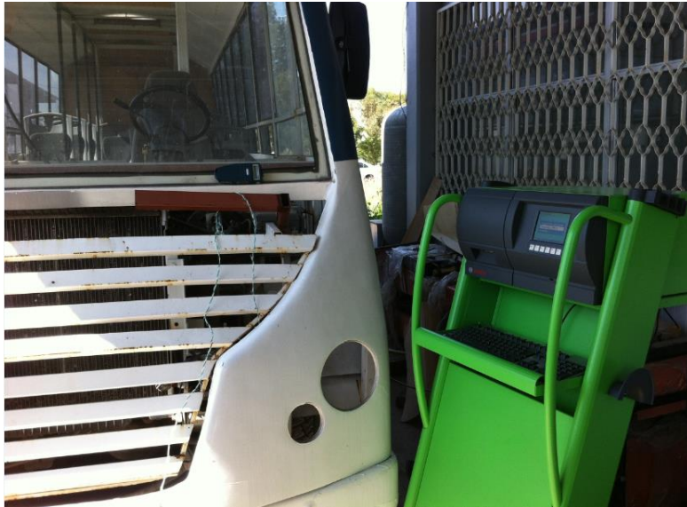
Figura 3.2.11 Colocación del analizador de emisiones Bosch.
