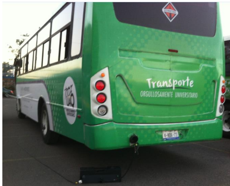
Figura 3.3.5 Colocación del opacímetro y la sonda.
