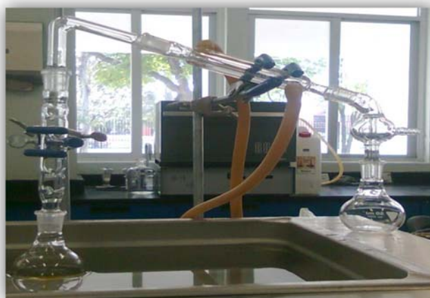
Figura 5. Equipo Kuderna-Danish utilizado para concentrar los extractos de aroma de mango.
