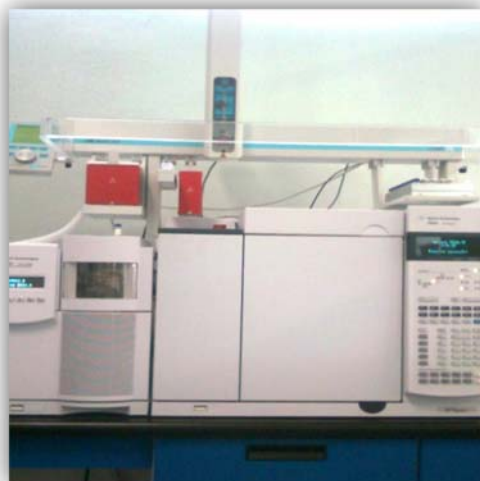
Figura 7. CG-MS. Equipo de cromatografía acoplado a masas utilizado para la separación e identificación de los compuestos volátiles del mango.
