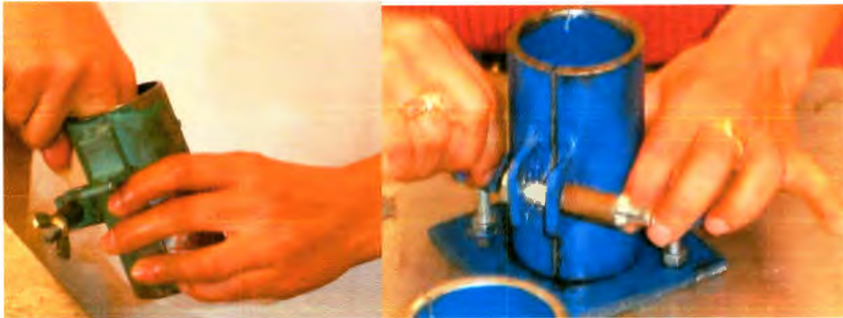
Figura 2. Preparación de los moldes para mortero.
