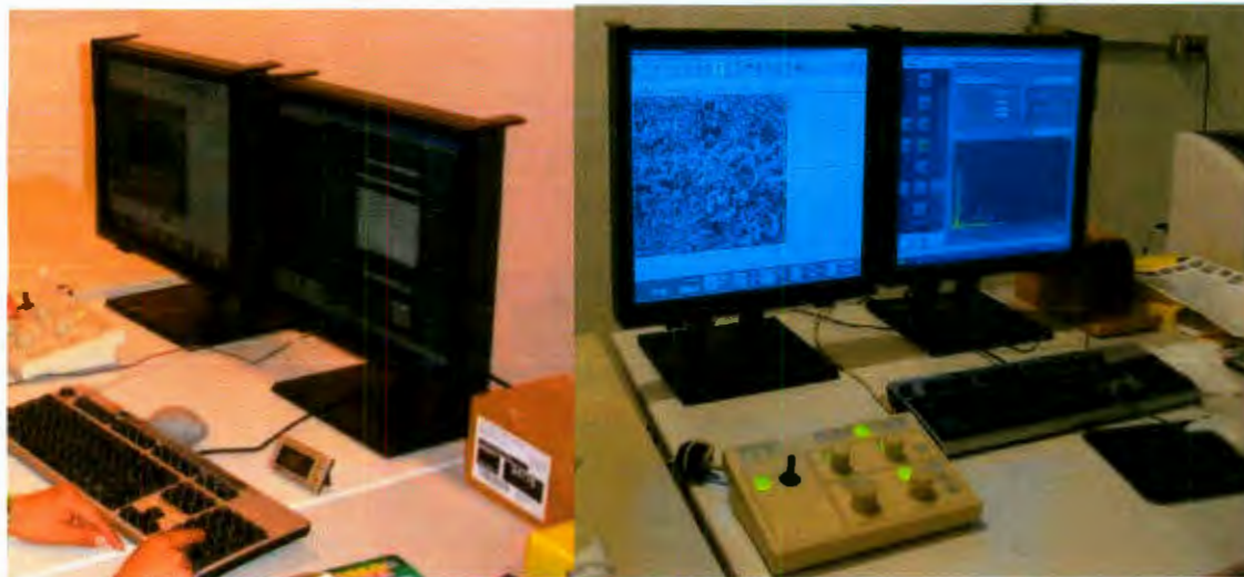
Figura 17. Pantalla de imágenes (MEB); pantalla para análisis semi-cuantitativos (EDS).
