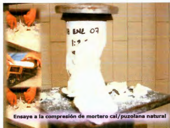
Figura 6. Ensayo a compresión de probeta de mortero.
