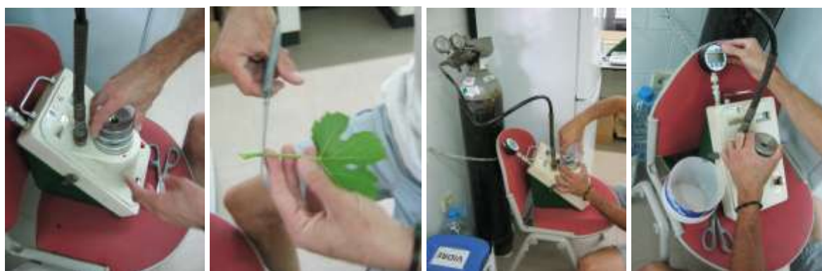
Figura 2.7 Cámara tipo Scholander (izq.), corte del peciolo para refrescar la herida (centro izq.), colocación de la hoja dentro de la cámara y cierre hermético (centro der.), incremento de la presión y registro al momento de aparecer la primera gota en el peciolo (der.).
