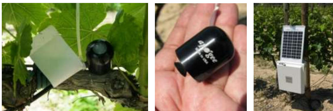
Figura 2.9 Medidores de radiación solar (izq. y centro) y panel solar como fuente de energía para el equipo (der.).
