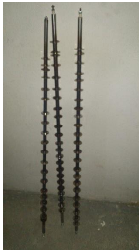
Figura 3. 37 Resistencias aletadas 220v 1800watts
