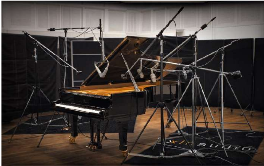
Figura 1.1 Equipo requerido para la captación sonora profesional de un piano acústico durante una sesión de grabación.
