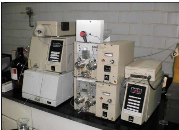
Figura 5.19. Cromatógrafo HPLC Waters 510 con arreglo de diodos utilizado para identificar y cuantificar capsaicina de las muestras de chile habanero.
