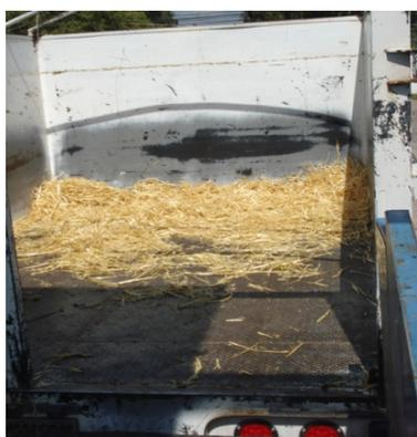
**Imagen 12.** Piso de lámina con paja como aislante en transporte para porcinos.
