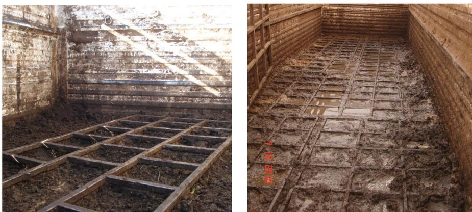
**Imagen 30 y 31.** Presentación de vehículos bovinos con un inadecuado diseño de las cuadrículas o rejillas antideslizantes, con presencia importante de heces y orina.
